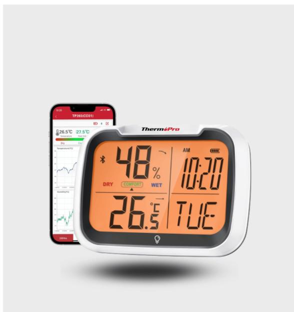
TP393 est équipé de la technologie de 5.0 de Bluetooth. Et ses données seront transférées à l'application de téléphone via la technologie Bluetooth. La portée à distance entre l'appareil et le téléphone est jusqu'à 80 mètres.
