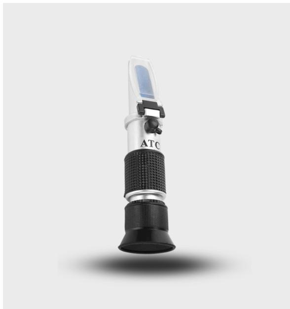
Ce réfractomètre optique à 4 échelles est conçu pour mesurer les liquides de refroidissement et les antigels à base d'éthylène glycol ou de propylène glycol, et mesurer l'état du liquide de la batterie (la densité de l'électrolyte et chaque division d'échelle correspond à 0.01g/cm<sup>3</sup>). Il mesure également l'antigel de lavage d'écran (liquide de lave-glace) basé sur l'éthanol aussi bien que sur l'alcool isopropylique. Et vérifiez la concentration d'urée dans l'AdBlue.
